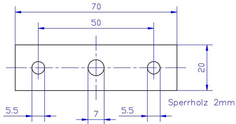
Unterflur-Montageplatte für Peco-Antrieb
